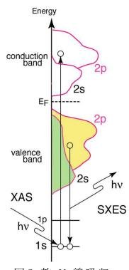
図6:軟 X 線吸収、 発光分光の原理
