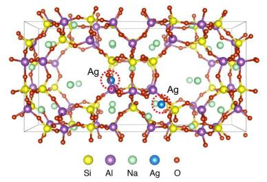
図2:DFT 計算によって得られた銀を含む 4A ゼオライトの原子配置
