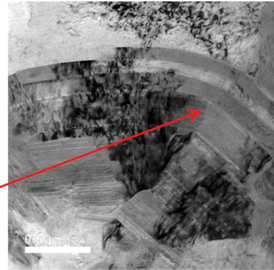
高温押出加工によりLPSO相に導入されたキンク帯
