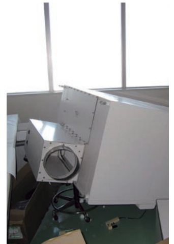
倒壊した安全キャビネット
